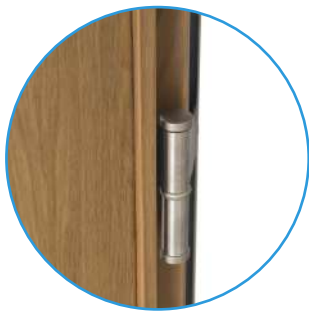
3 Bisagras con rodaminetos soldadas a la hoja y atornilladas al marco
